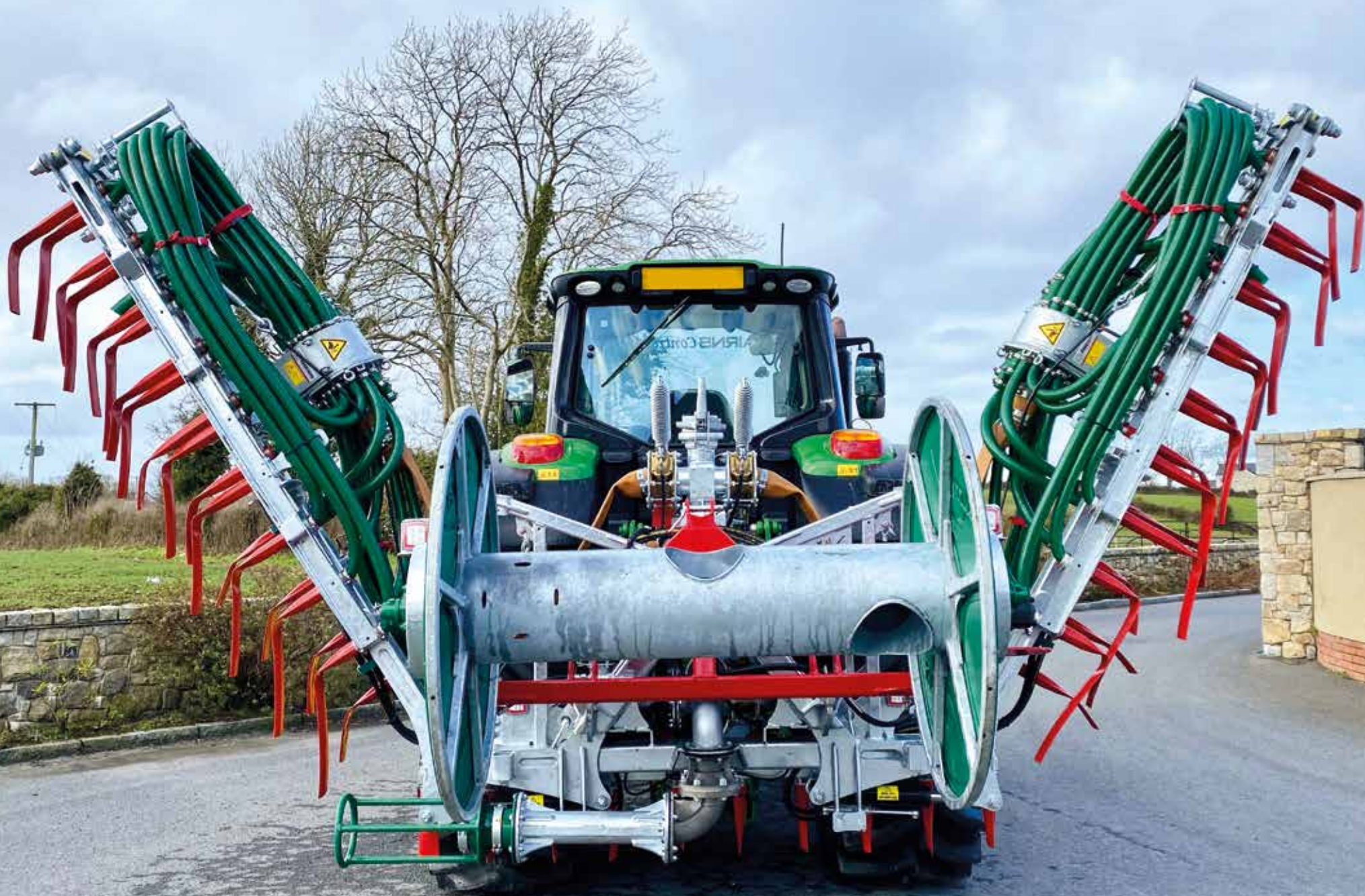
800 m trommel montert på 12 m spredebom
