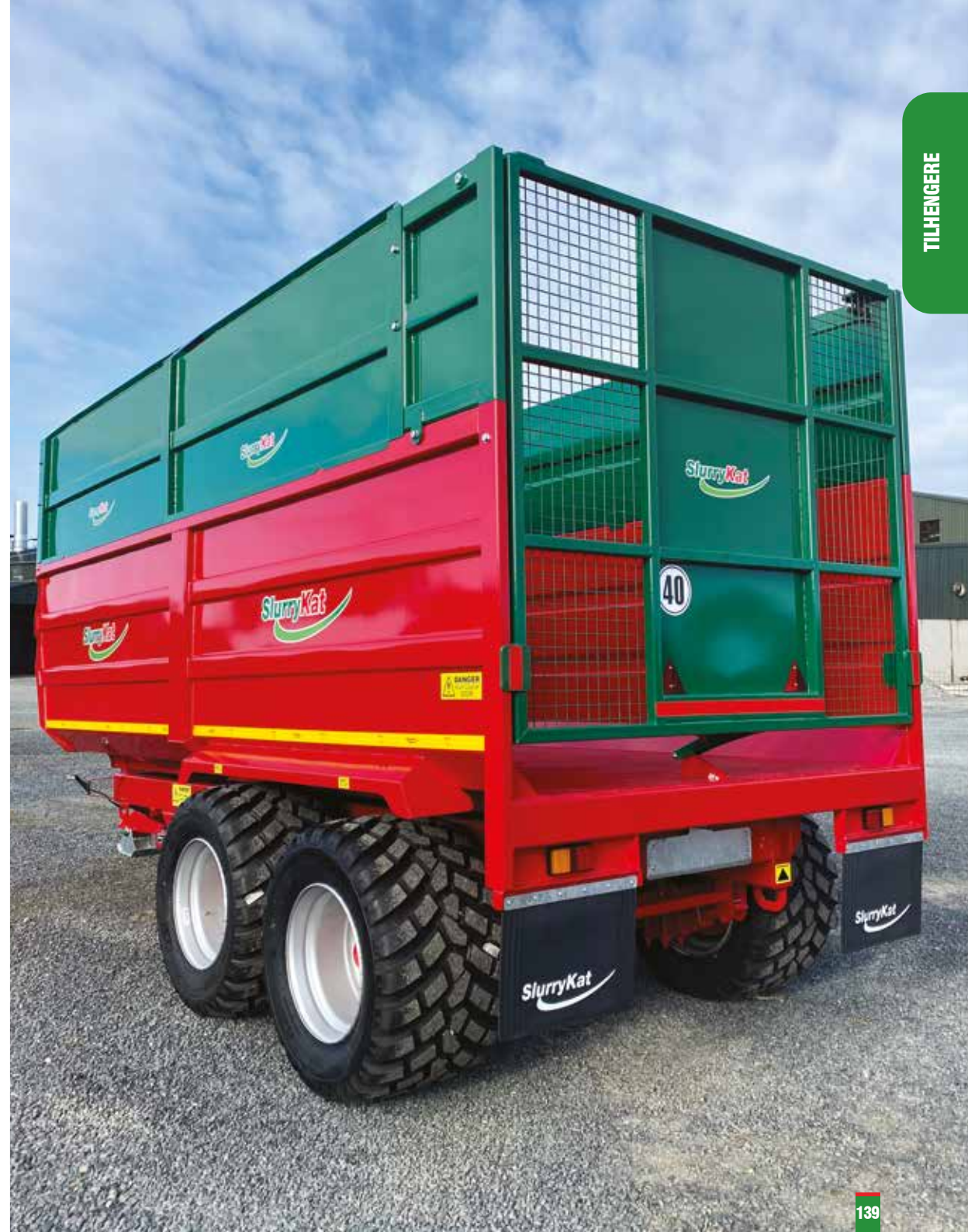
14 T/18 ft Panterra grashenger med 560/60 flotasjonsdekk og semiautomatisk bakluke
