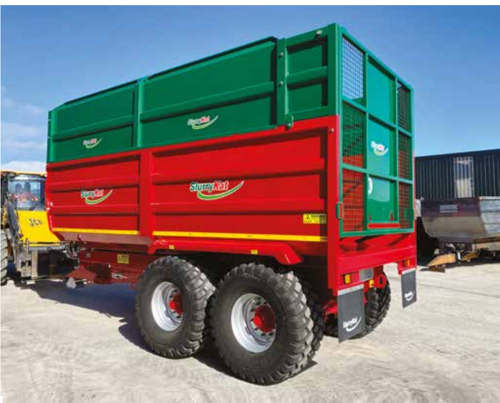
14 T/18 ft Panterra grashenger med 560/60 flotasjonsdekk og semiautomatisk bakluke
